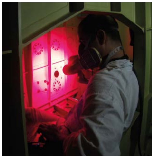
Vor der Reparatur wird der beschädigte Bereich der vorderen Tragfläche gescannt.
